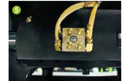
5 集中潤滑模塊 Centralized lubrication module
